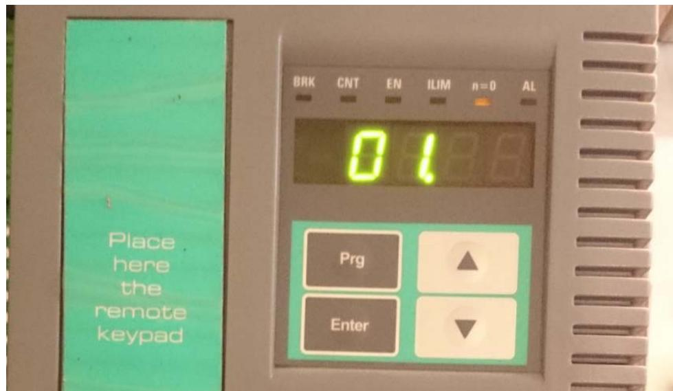
از کلید Prg برای رفع پیغام خطا و خروج از پارامتر و بازگشت به منوی قبلی استقاده می شود. کلید Enter برای انتخاب پارامتر و یا ورود به منو و تغییر پارامتر بکار می رود. کلیدهای جهت بالا و پایین هم برای افزایش و کاهش مقدار پارامتر و یا حرکت در بین منو ها کاربرد دارد. لامپ های LED بالای کی پد وضعیت کنتاکتور ترمز و کنتاکتور اصلی و Enable بودن درایو و حد جریان و سرعت غیر صفر و خط ر روی درایو را نشان می دهند.
