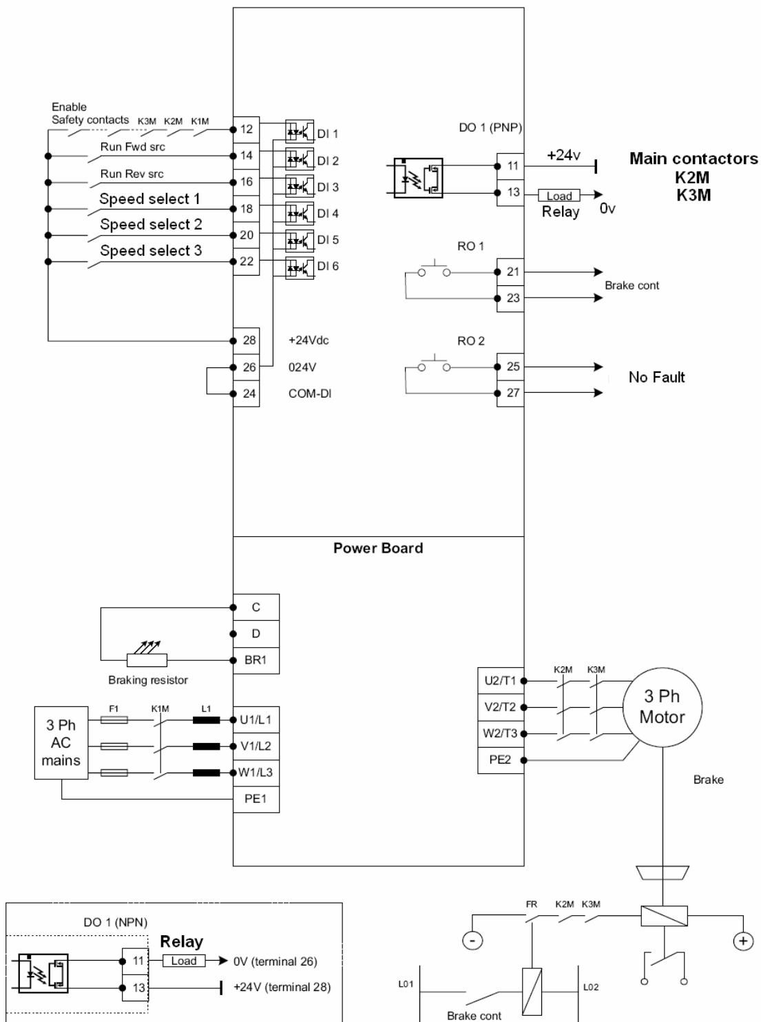
در ایو AGL50 دارای یک ورودی آنالوگ ، یک خروجی آنالوگ ، 6 ورودی دیجیتال و 3 خروجی قابل برنامه ریزی است. در تابلوهای آسانسوری معمولاً از ورودی ها و خروجی های آنالوگ استفاده نمیشود. بنابراین فقط 6 ورودی دیجیتال و 3 خروجی رله ای و ترانزیستوری موجود، برای کنترل موتور آسانسور، کافیت میکند.
